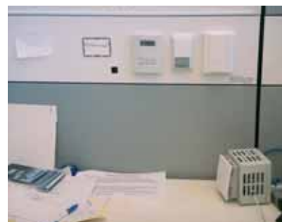
Et kig ind i et af testområderne, hvor de studerende arbejder på samme måde som andre steder på universitetet – eneste forskel er, at de udsættes for varierende temperaturer, ligesom CO 2 -niveauet måles flere steder i lokalet.
