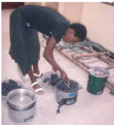
Kig ind i universitetets testlokale, hvor der lige afprøves forskellige former for ovne. De testes for bl.a. energieffektivitet og forurening.
